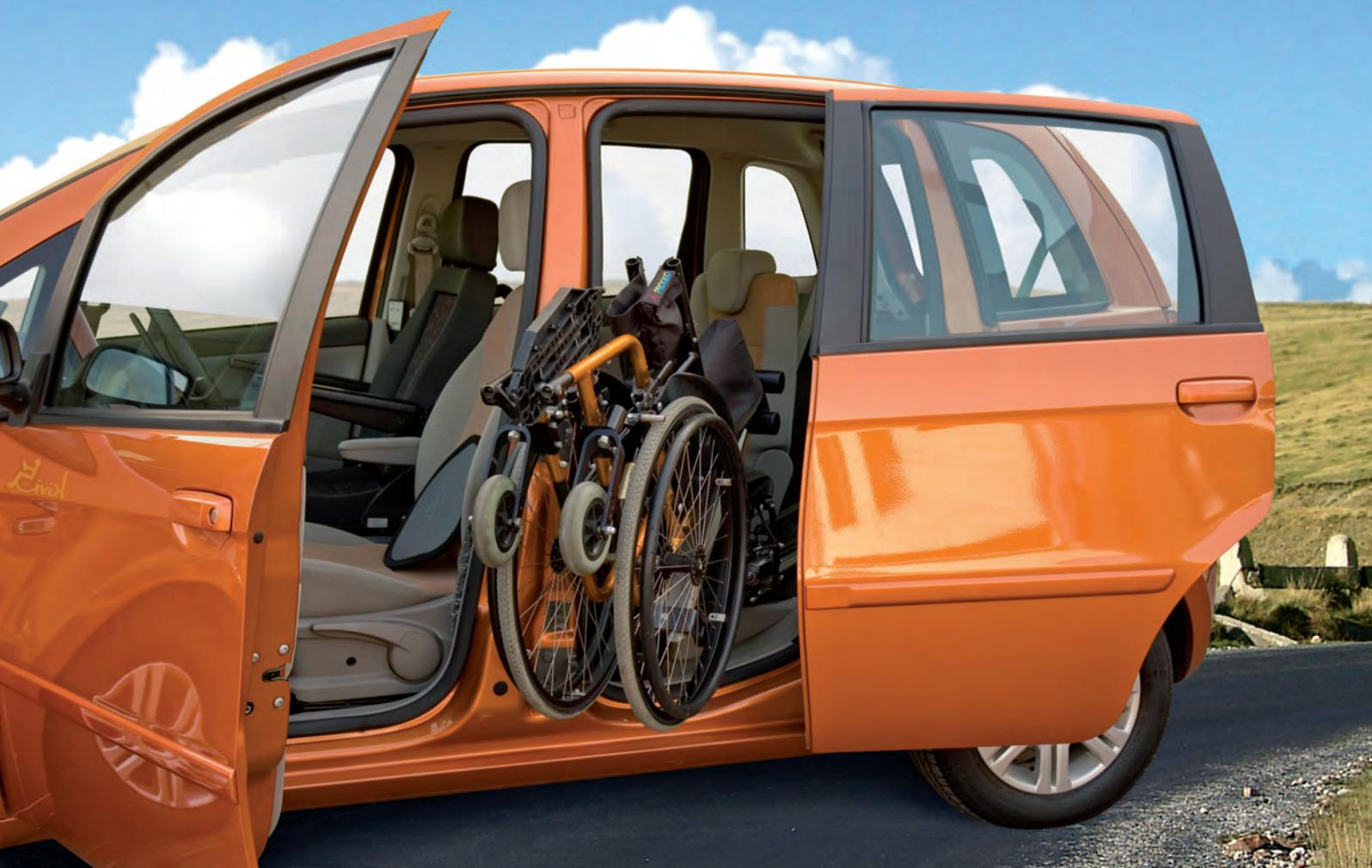
Facilita il caricamento della carrozzina nella parte posteriore della vettura. Può essere installato su vetture a cinque porte. Quando la portiera ha raggiunto la sua massima apertura, il braccio, controllato da una pulsantiera, fuoriesce ed aggancia la carrozzina sistemandola in modo stabile all'interno dell'abitacolo. Tutto il ciclo avviene in breve tempo. Richiede l'installazione della porta rototraslante o di una porta scorrevole laterale. E' dotato di sistemi di sicurezza, per cui:
